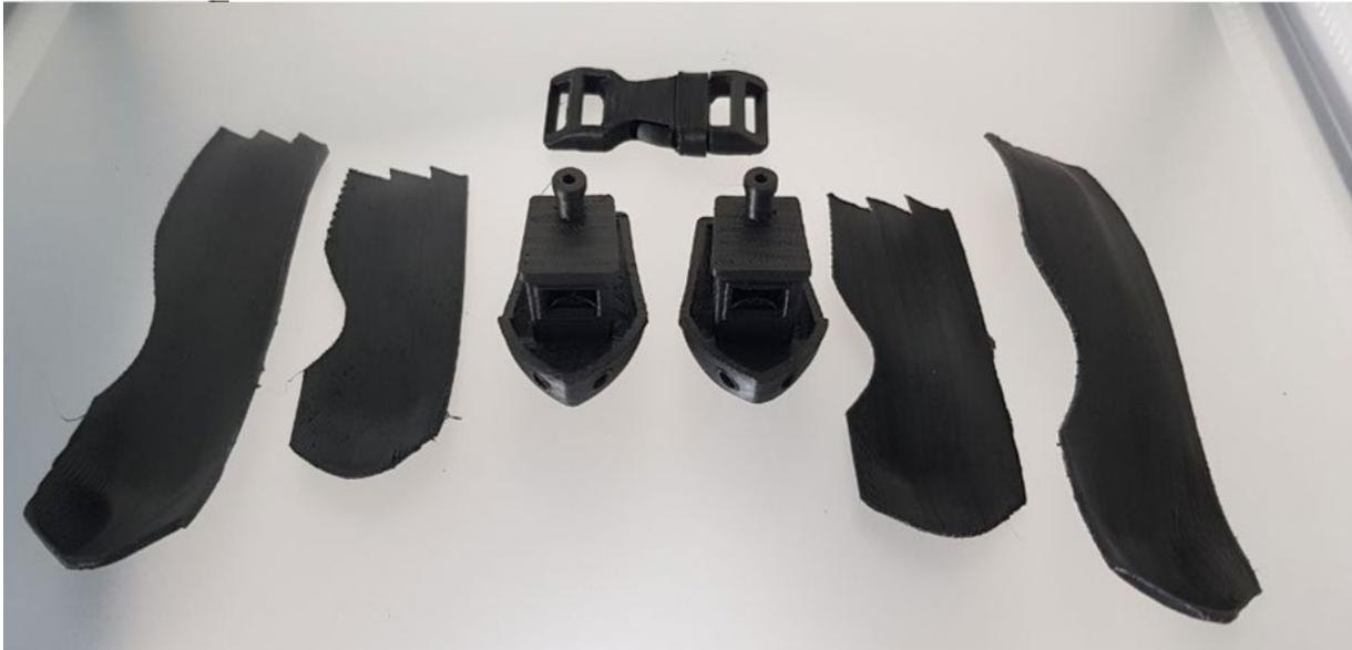
Abbildung 5: Drucktest-Modelle aus Recycling-Filament
