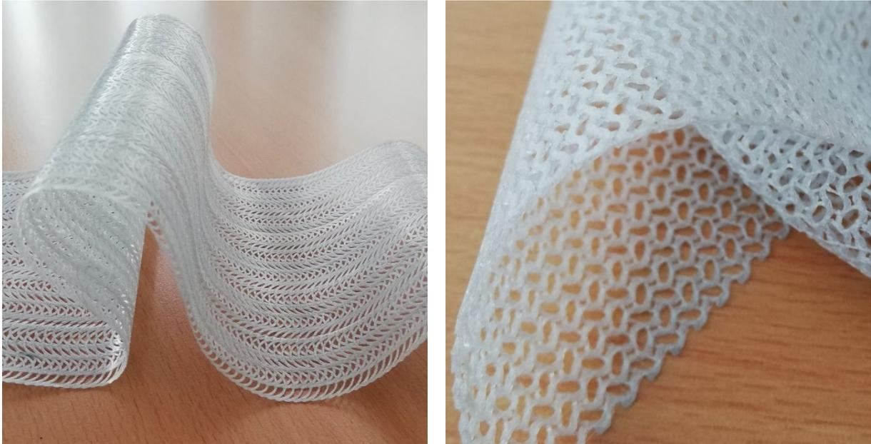
Abbildung 14: Flexibilität von TPU
