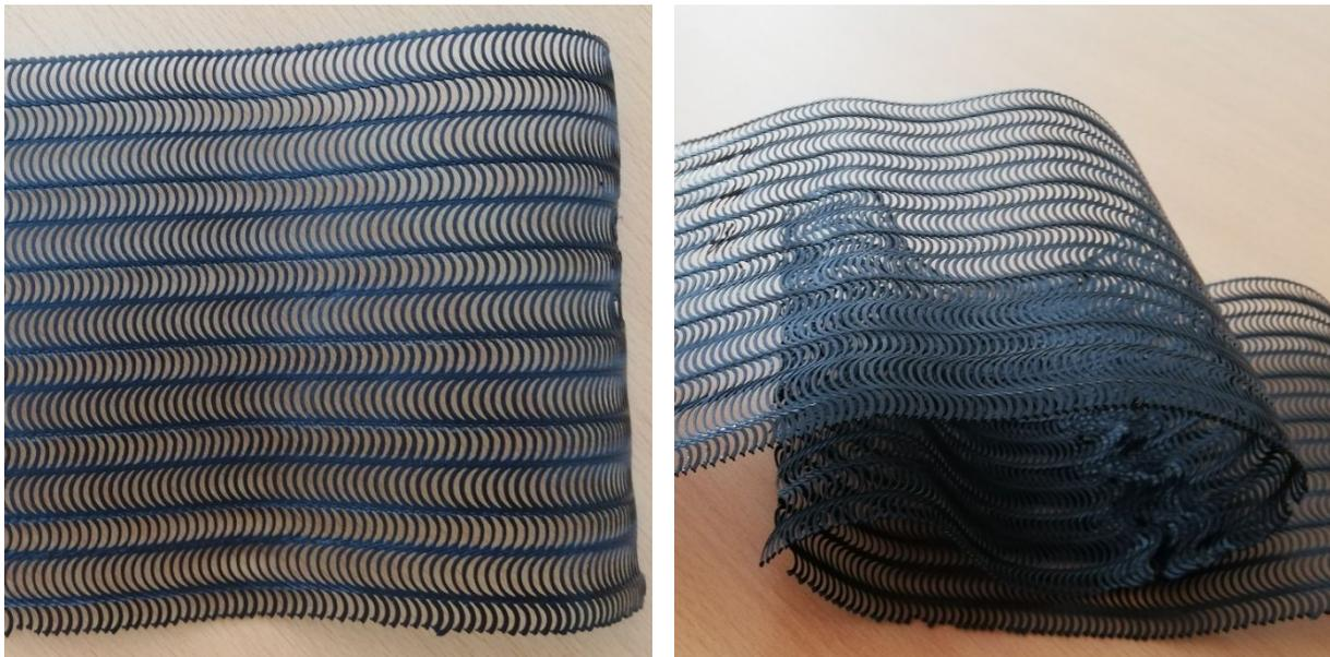
Abbildung 15: Struktur, Muster und Flexibilität von R-PP
